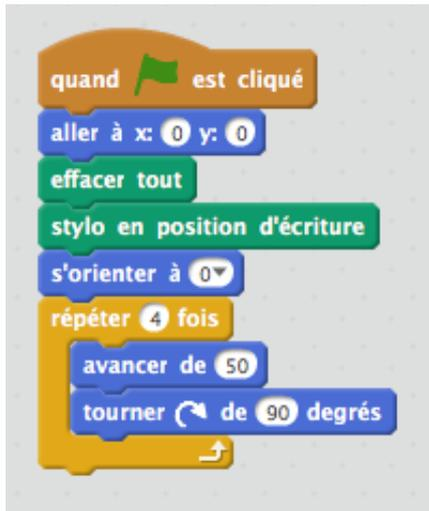
FIGURE 12.1 – Tracé d'un carré avec boucle
