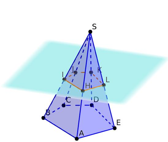
FIGURE 3.18 – Section d'une pyramide par un plan parallèle à la base
